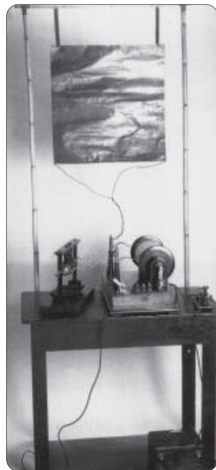
Il "Tavolino": primo apparecchio trasmettitore realizzato da Guglielmo Marconi con un'antenna formata da una lastra di latta ricavata da un bidone di petrolio per lume. Stupì il mondo intero, quando Marconi se ne servì a Bologna per lanciare alcuni dei primi segnali di telegrafia senza fili (Fondazione Marconi, collezione Maurizio Bigazzi, foto Cesare Gualdoni).
